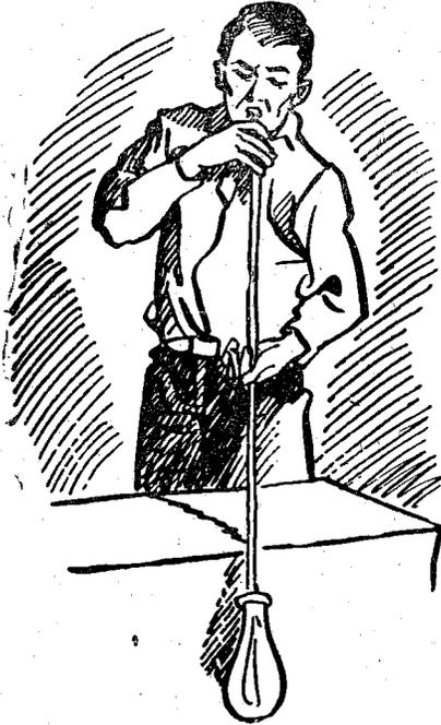
Şekil: 33 — Camın üflenerek işlenmesi.
