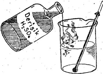
Şekil: 11 — Derişik  $H_2SO_4$  suyla karışırken çok ısınır.
